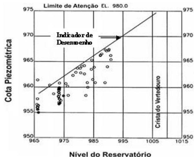
FIGURA 2 – Exemplo de Valores de Controle para a instrumentação (adaptado de USACE [6]).
